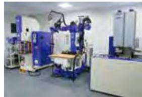
同社は従業員数35人の溶接機メーカー。1988年に開発した「テーブルスポット溶接機」という、他社も手掛けないタイプを専門に扱っている。テーブル型で多関節ロボットアームを使い、奥深い箱物の溶接作業ができるものだ。コピー機や配電盤、自動販売機の筐体など、用途も幅広い。2012年には、溶接時間がなんと0.01秒という
